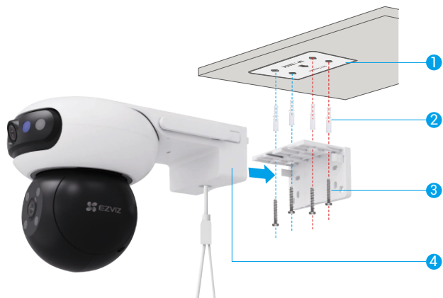
Slika 1. Montaža na plafon
